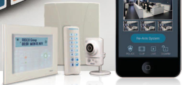
LightSYS™2 es el único sistema de seguridad híbrido que ahora ofrece mucho más. LightSYS™2 es compatible con VUpoint, la novedosa solución de video-verificación en tiempo real de RISCO Group. VUpoint está basada en la Nube y utiliza Cámaras IP para proporcionar la transmisión de video en tiempo real cuando se activa una alarma o bajo petición.
