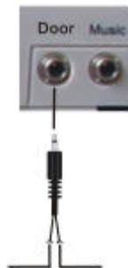
No conecte el circuito de la cerradura directamente a los contactos de este relé. Las cerraduras eléctricas tradicionales funcionan con una carga nominal que puede exceder la capacidad de este relé y la capacidad de contacto del plug de 3,5mm y consecuentemente puede dañar la central.
