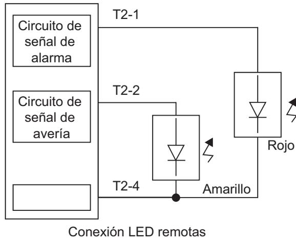
Figura 3-14: Diagrama de cableado (LED remotos)
