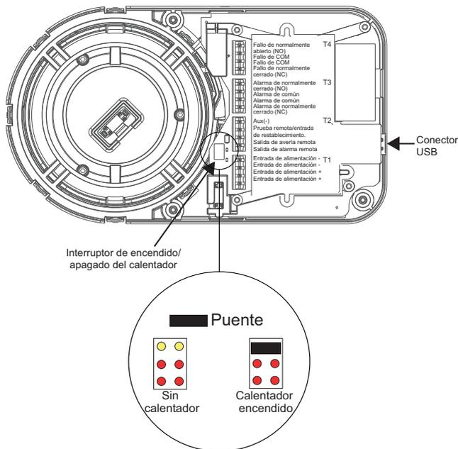
Figura 3-12: Conexiones de cableado en el detector
