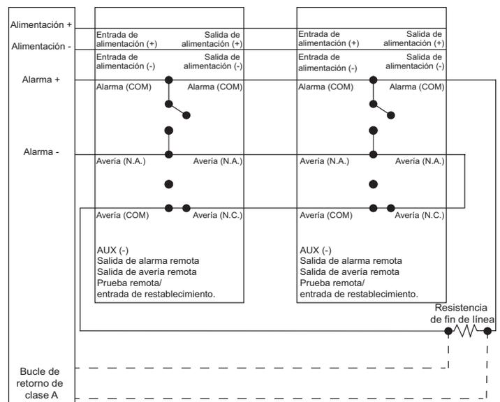
NOTA: si se instalan otros detectores en el mismo lazo, se requiere un módulo de supervisión de alimentación de la línea aprobado.
