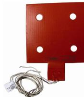
La unidad BEAMHKR permite que el reflector funcione en ambientes propensos a la formación de condensación. La condensación que se forma en el reflector puede dar lugar a avería o condiciones de falsa alarma. La unidad BEAMHKR disminuirá la probabilidad de condensación manteniendo el reflector a una temperatura ligeramente superior al aire circundante. El kit requiere una fuente de alimentación de 24 V.
