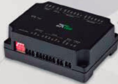
DM10 es una placa de expansión de bloqueo de puerta. Se puede usar con los dispositivos independientes de control de acceso que tienen la función de comunicación RS485, como el F18. DM10 no contiene ninguna información del usuario, todos los datos están en los dispositivos de Control de Acceso, la placa solo controla el bloqueo.
