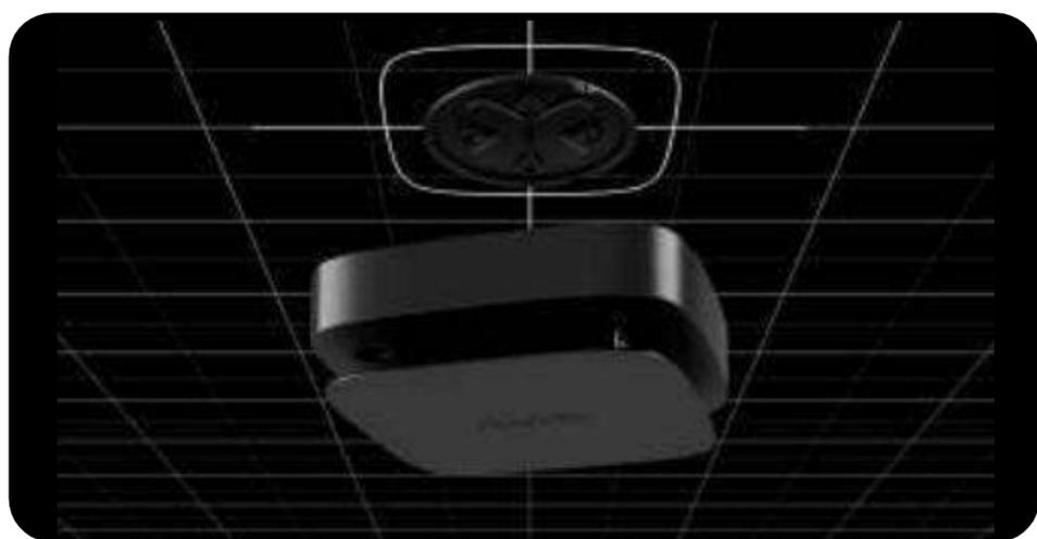
Para instalar el FireProtect 2, no hace falta desmantelar la carcasa del detector. Las baterías reemplazables o integradas están preinstaladas, y el panel de montaje SmartBracket se puede quitar del detector sin herramientas adicionales. El panel de montaje SmartBracket tiene un grado de libertad de 90°. Esto permite al instalador nivelar la posición del detector después de instalarlo.
