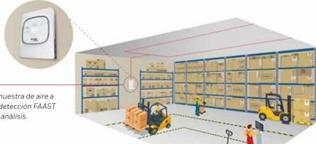
El aire se aspira a través de un aspirador de velocidad regulable. Cada entrada de las tuberías se caracteriza por un sensor de flujo de aire que controla los cambios de flujo de aire en las mismas.
