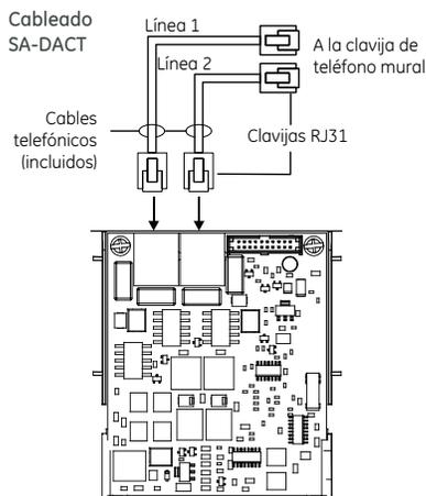
Las líneas telefónicas del marcador se conectan a los conectores de la tarjeta principal del marcador. La línea telefónica 1 se conecta al conector J4 y la línea 2 al conector J1.
