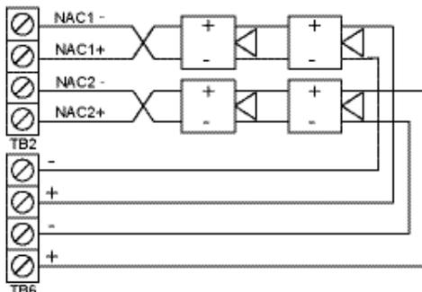
Las marcas indican la polaridad de la señal de salida cuando el circuito está activo. La polaridad se invierte cuando el circuito no está activo. Cablee los dispositivos de notificación del modo correspondiente. La polaridad de los dispositivos de notificación del gráfico corresponde al estado activo.
