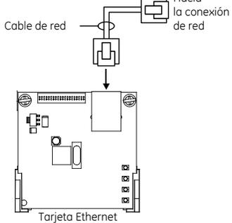
La tarjeta SA-ETH provee una conexión de red Ethernet Base T 10/100 estándar para conectarse a una intranet, a una red local o a Internet. La tarjeta puede ser usada para descargar programas de configuración del iO-CU al panel a través de la red. La tarjeta Ethernet se instala en el conjunto plástico y se conecta a la tarjeta principal mediante un cable plano.
