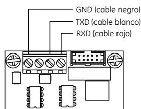
La tarjeta RS-232 se instala en el conjunto plástico y se conecta a la tarjeta principal mediante un cable plano.
