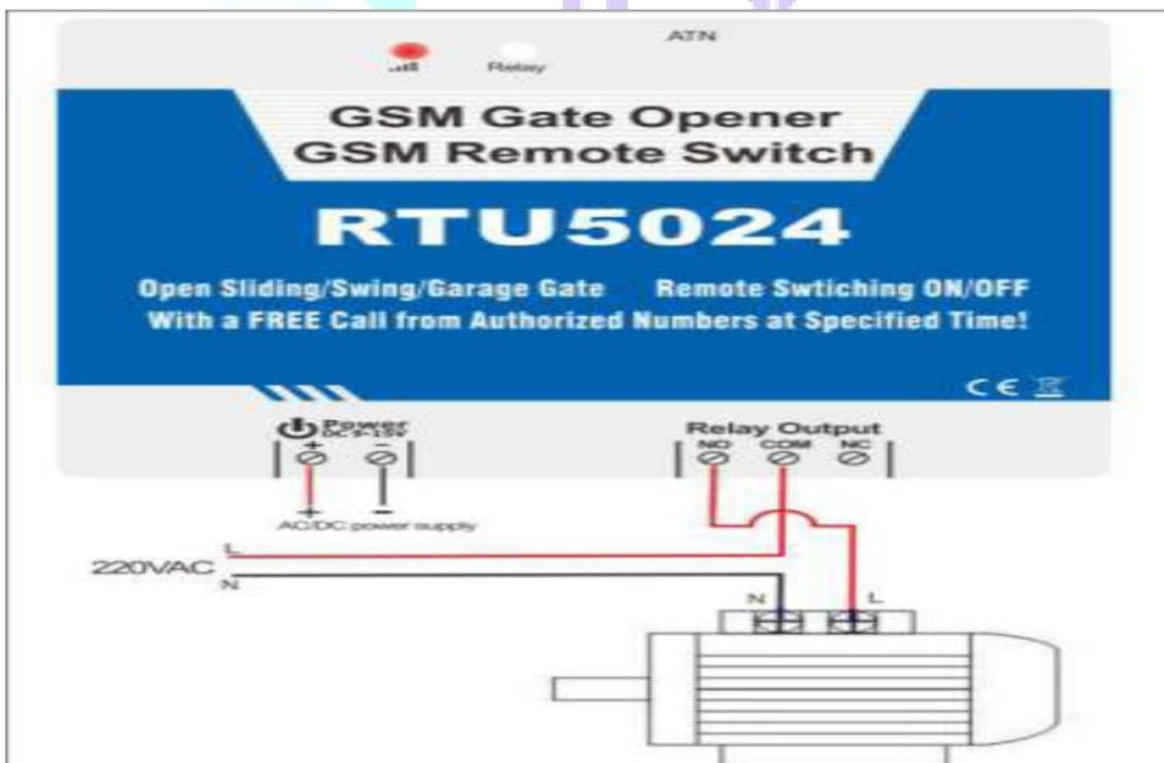
Para conexión de motores y otros dispositivos de voltaje superior, utilice fuentes de alimentación individuales.
