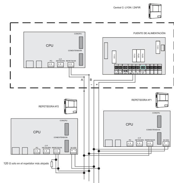
Figura 7. Esquema de conexionado para Zafir y Compact Lyon
