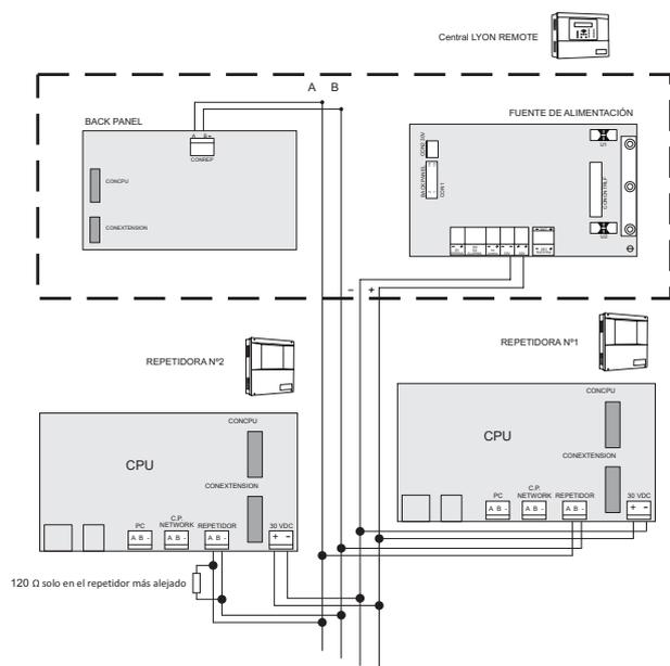
Figura 6. Esquema de conexionado para una central Lyon Remote
