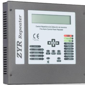
La central LYON REMOTE / ZAFIR / COMPACT Lyon permite conectar hasta un máximo de 15 repetidores, mediante una conexión de 4 hilos de 1,5 mm<sup>2</sup> (dos de alimentación y dos de comunicación para la línea RS485). Los dos hilos de la línea RS485 se conectarán desde la central a los correspondientes repetidores. El conexionado de los repetidores se realiza como se muestra en la figura adjunta.
